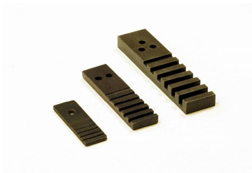
Рисунок 1 - Внешний вид эталонов чувствительности канавочных АРГО (вид сверху)
