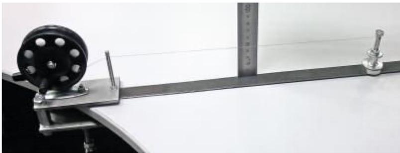
**Приспособление «СТРУНА»** является вспомогательным индикаторным инструментом для облегчения определения отклонений форм профиля поверхности совместно со средствами линейных измерений (линейками, индикаторами, угольниками, штангенинструментом).
