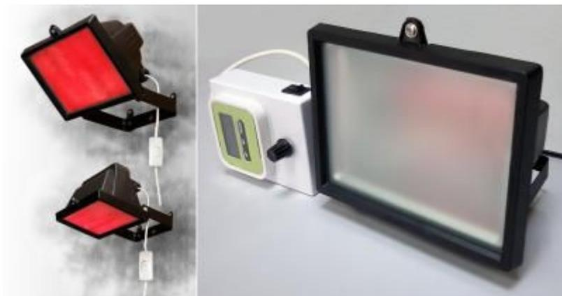
Фотофоны радиографические лабораторные с регулировкой яркости «ФНС стандарт» (Хамелеон) и «Хамелеон-Т» предназначены для работы с радиографическими плёнками всех классов чувствительности, в том числе с экранными. В фотофонарях используются специально подобранные мощные светодиоды с узким спектром излучения, обеспечивающим их неактиничность. Неактиничность приборов испытана на экранных пленках AGFA F8, P8Ф, FOMA RX-1, KODAK HS800, Тасма РТ-1 по методике ТУ 6-43-0205133-03-91.
