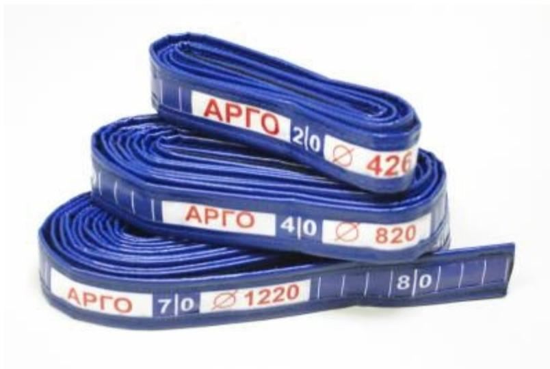
Пояс мерительный (маркировочный, мерный) со свинцовыми цифрами толщиной 1,6 мм (евростандарт) является вспомогательным инструментом для облегчения определения месторасположения дефектов сварного шва при проведении радиографического контроля.
