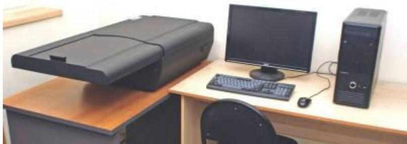
Для выполнения самых жестких требований по чувствительности контроля необходимо применять комплекс Барс – модель 15. Эта комплектация обеспечивает чувствительность контроля **по первому классу в соответствии с ГОСТ 7512-82.**
