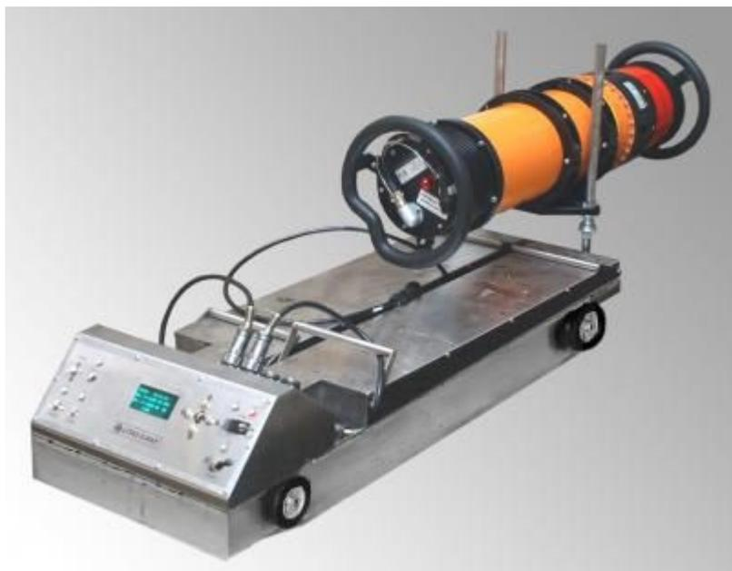
Кроулер - автономная самодвижущая тележка с микропроцессорным блоком управления, перемещающаяся внутри трубы и обеспечивающая работу рентгеновского аппарата.
